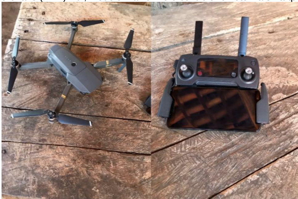
Figura 3: Aeronave (RPA) DJI, modelo Mavic Pro e controle remoto via smartphone.
