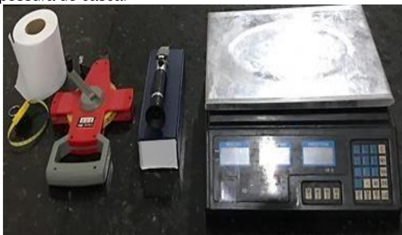
Figura 2. Instrumentos utilizados para aferição do brix, peso, comprimento e largura do fruto, e espessura de casca.
